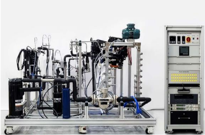
< 전기자동차용 히트펌프 시스템 테스트벤치 >
